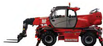
Rotazione su stabilizzatori estesi con braccetto 1500 kg EN 1459
